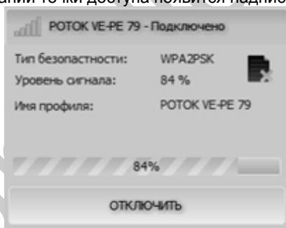
Для подключения к прибору перейдите в главное окно программы и нажмите кнопку . Появится поле ввода IP адреса. Введите IP адрес по умолчанию 192.168.4.1. Затем установите переключатель в положение ВКЛ.
