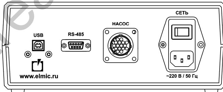
Рисунок 2. Панель задняя
