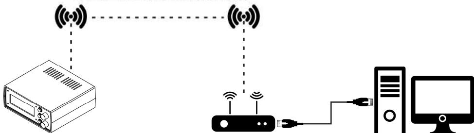
Рисунок 10. Подключение компьютера к прибору через маршрутизатор
