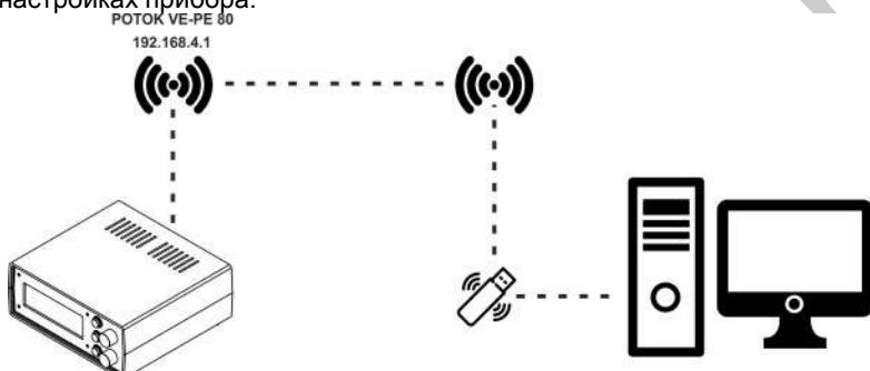
Рисунок 9. Подключение компьютера к прибору через USB адаптер
