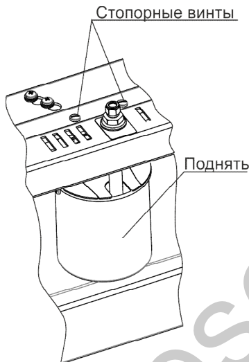
Рисунок 2.3 – Перевод Устройства в транспортное положение
